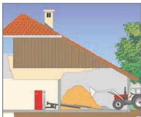
Silo de plain-pied à large accès avec remplissage direct.
