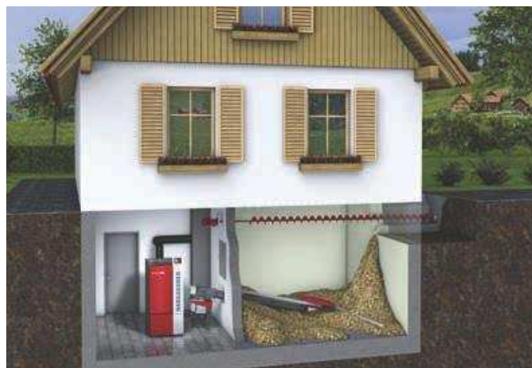
Chaudière et silo en sous-sol :
