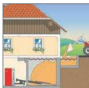
Remplissage automatique dans une cave
